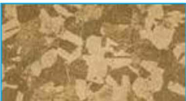
El mismo acero, luego de ser deformado en frío por estirado, con una reducción de sección del 25%.
