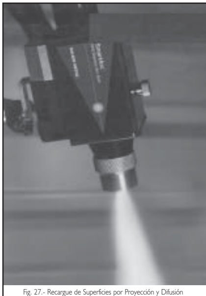
Fig. 27.- Recargue de Superficies por Proyección y Difusión
