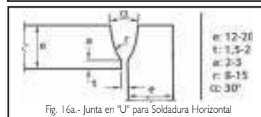
Fig. 16a.- Junta en "U" para Soldadura Horizontal
