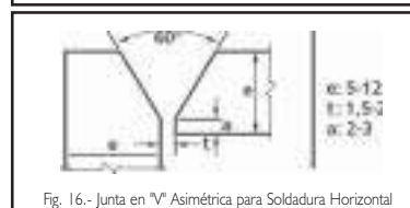
Fig. 16.- Junta en "V" Asimétrica para Soldadura Horizontal
