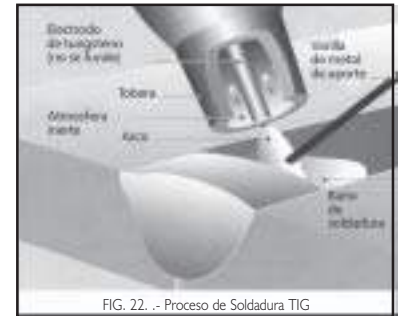
FIG. 22.- Proceso de Soldadura TIG
