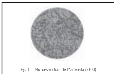
Fig. 1.- Microestructura de Martensita (x100)
