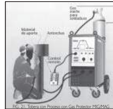
Fig. 21.- Tobera con Proceso con Gas Protector MIG/MAG
